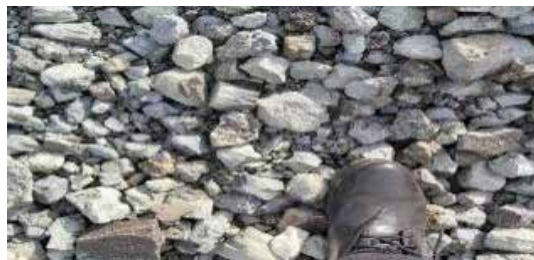
Gambar 1. Slag hasil pendinginan air (a) dan pendinginan udara (b)
