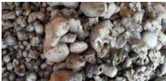
Gambar 1. Slag hasil pendinginan air (a) dan pendinginan udara (b)
