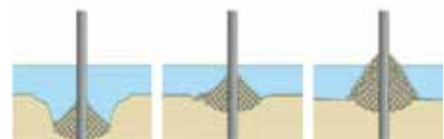
Gambar 5. Penggunaan batuan rip-rap di sekitar pilar jembatan (Harasti dkk, 2021)
