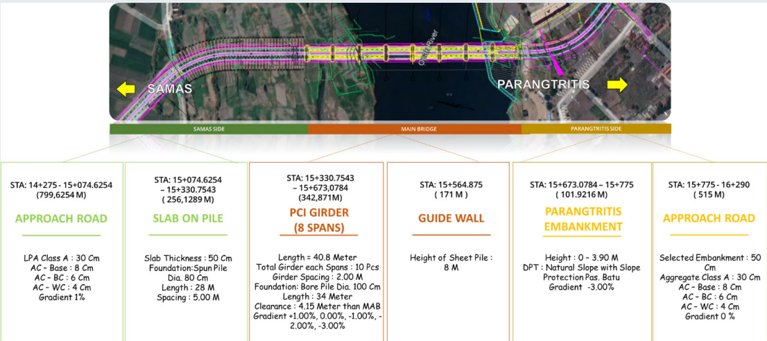
Gambar 10. Konfigurasi Struktur Jembatan Kretek 2 (Balai Besar Pelaksanaan Jalan Nasional Jawa Tengah – D.I. Yogyakarta, 2023)
