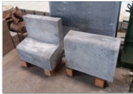
Gambar 3. fly ash untuk beton tanpa semen (trotoar dan kerb jalan) Pusjatan 2016
