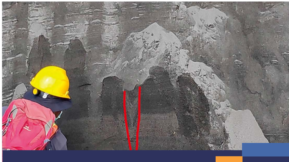
Gambar 4. Foto bukti Sesar Opak (hasil uji paritan paleoseismologi) memotong lapisan gumuk pasir dengan lebar zona sesar sekitar 100 mm (sumber : Danny H.N. dkk, 2021)
