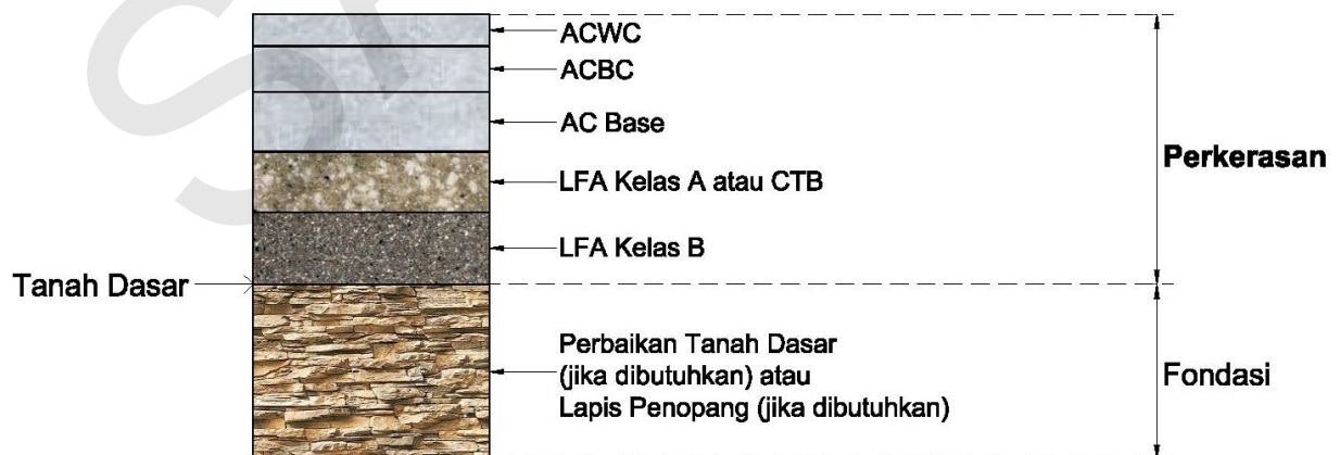
Gambar 1.1. Tipikal Struktur Perkerasan Lentur.
