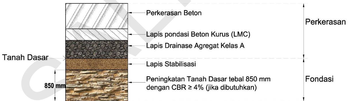
Gambar 1.2. Tipikal Struktur Perkerasan Kaku.
