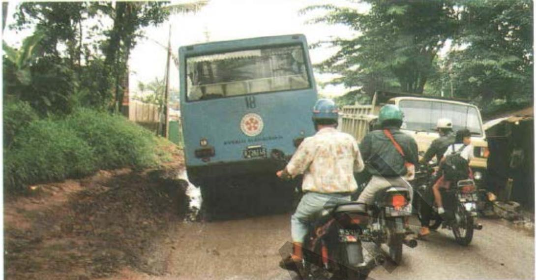
**Gambar 8. Penurunan/Ambles Pada Permukaan Tidak Jalan Beraspal**
