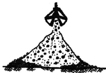
Gambar 10 - Penimbunan dengan cara membentuk gunung seperti ini dapat menjadikan pemisahan butiran kasar pada bagian lerengnya
