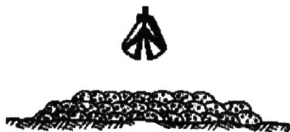
Gambar 11 - Material ditumpuk sendiri-sendiri secara berlapis, tidak terjadi kemungkinan turunnya material ke bawah
