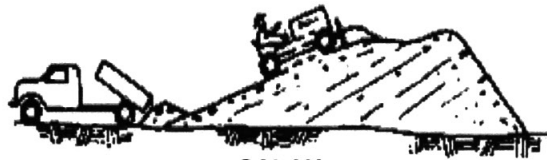
Gambar 3 - Penumpukan lapisan-lapisan material oleh bulldozer dengan kelandaian lereng lebih dari 3:1, kecuali untuk material tertentu yang memungkinkan kelandaian lebih dari 3:1
