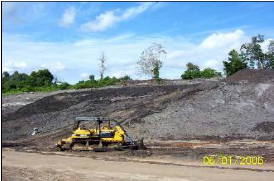
Gambar 3.1. Penambangan Asbuton secara terbuka
