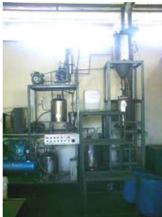
Gambar 7.2b Foto alat ekstraksi asbuton (model)
