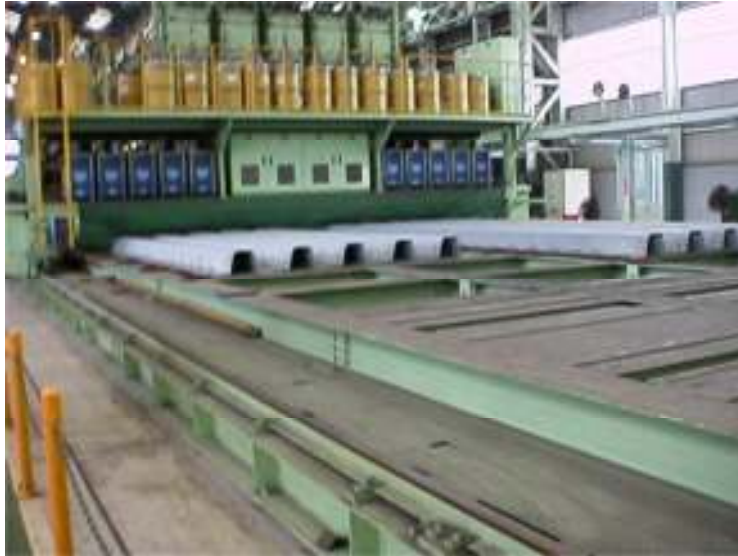
Gambar 1.1. Pembuatan pelat baja ortotropik di pabrik baja
