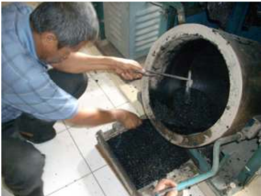
Gambar 2.14. Proses pencampuran, penuangan bahan perkerasan pada cetakan di atas pelat uji yang telah diberi lapisan cat
