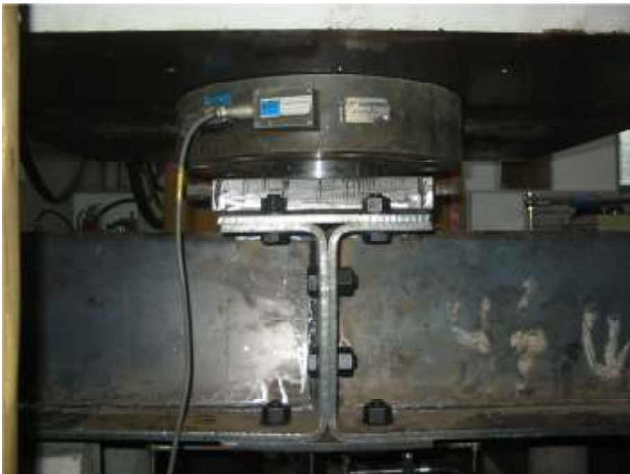
Gambar 2.9. Kondisi sambungan sebelum pengetesan pada spesimen 3
