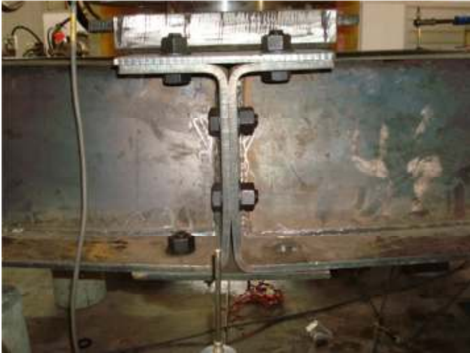
Gambar 2.10. Kondisi sambungan setelah pengujian berakhir pada spesimen 3
