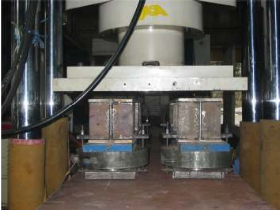
Gambar 2.6. Penempatan beban untuk benda uji spesimen 1
