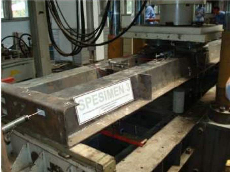
Gambar 2.8. Penempatan beban untuk spesimen 3
