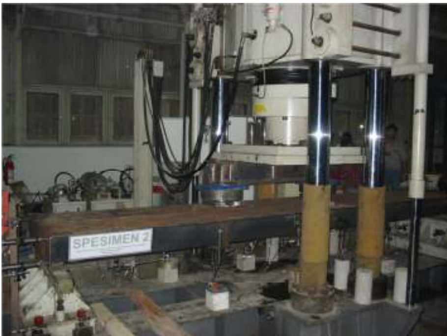
Gambar 2.7. Penempatan beban untuk spesimen 2
