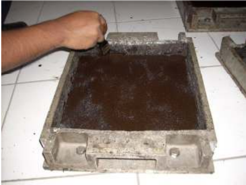
Gambar 2.13. Proses pemberian lapisan tackcoat di atas pelat uji
