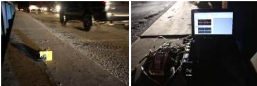
Gambar 5.14 Penempatan sensor accelerometer dan alat perekam data
