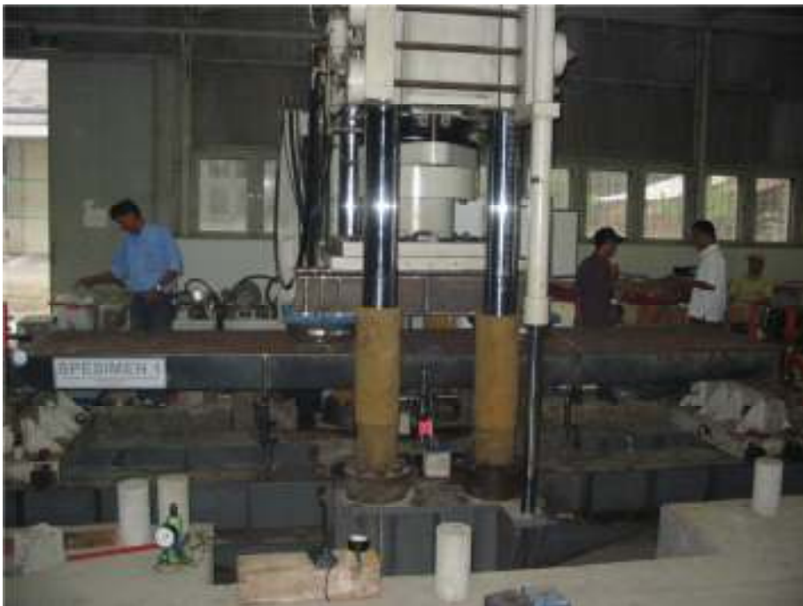
Gambar 2.5. Tampak samping benda uji pelat baja ortotropik
