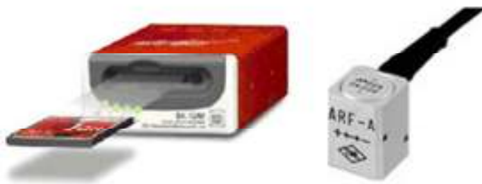
Gambar 5.13 Data Recorder dan sensor percepatan
