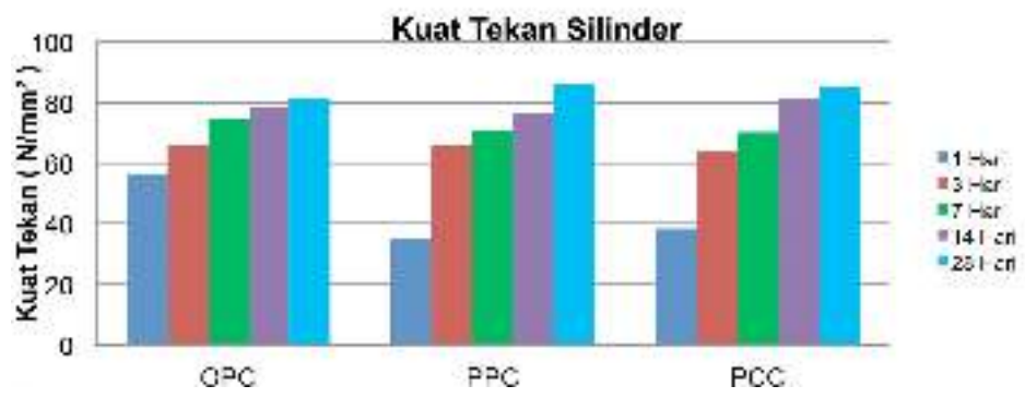
Gambar 11. Kekuatan tekan dari benda uji silinder pada berbagai umur
