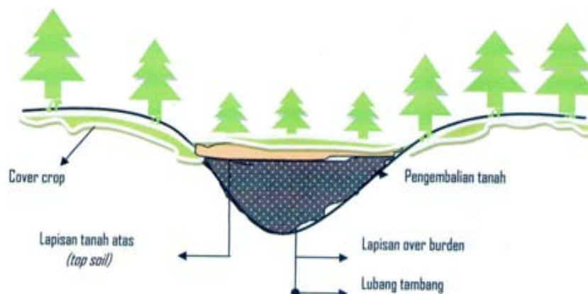
Gambar 4.1-2 Sketsa reklamasi lahan bekas penambangan asbuton dengan pengembalian tanah lapisan atas dan overburden pada galian bekas penambangan
