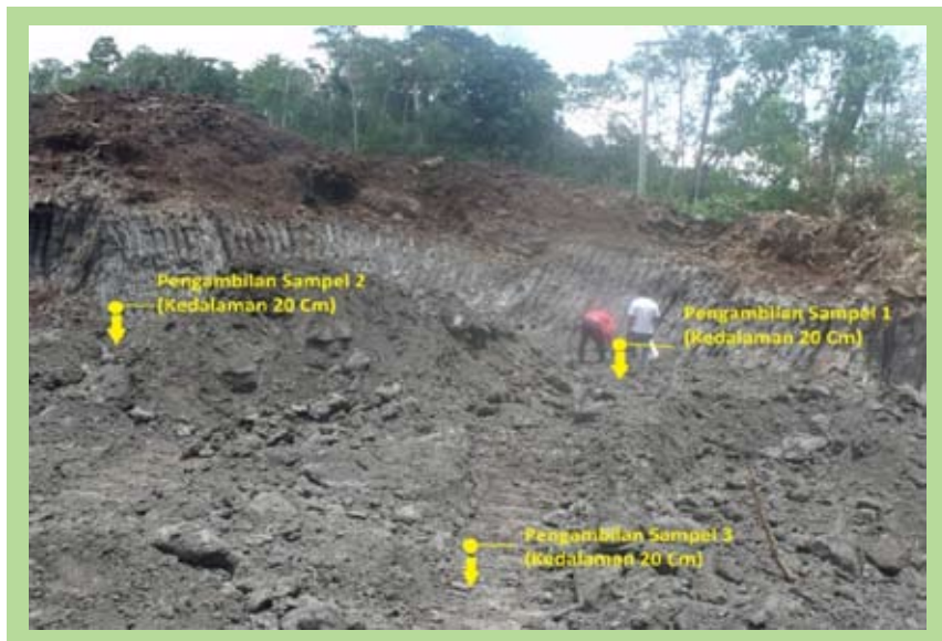
Gambar 3.1-1 Pengambilan sampel asbuton di pertambangan.
