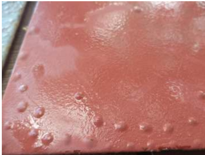
Gambar 6.4. Kondisi Lapis Lindung Cat yang Sudah Mulai Menggembung Setelah Periode Perendaman 6 Bulan
