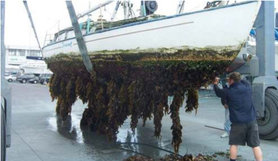
Gambar 4.2. Pengelupasan Biota Penempel Secara Mekanis ( Scrapping )
