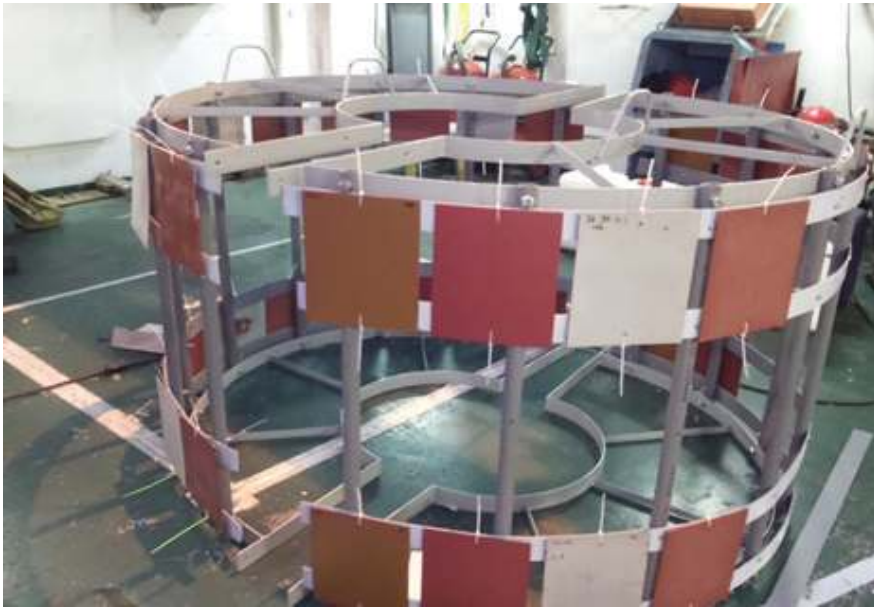
Gambar 5.1. Contoh Uji Penelitian Sesuai ASTM 3623-78
