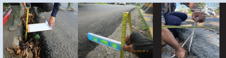
Gambar 50 Ilustrasi kode kerusakan 724 Lapis permukaan yang berlebih
