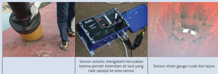
Gambar 72 Ilustrasi kode kerusakan 942 Retak/rusak/tidak berfungsi
