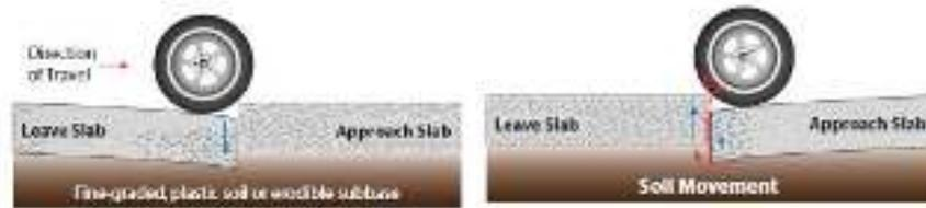
Gambar 3.2 Mekanisme terjadinya *pumping*
