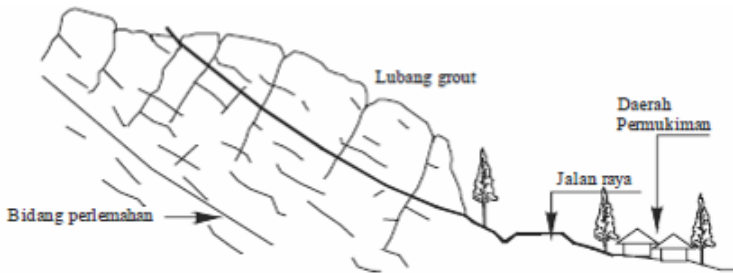
Gambar 4.4 Menutup Rekahan (Departemen Pekerjaan Umum, 2005)
