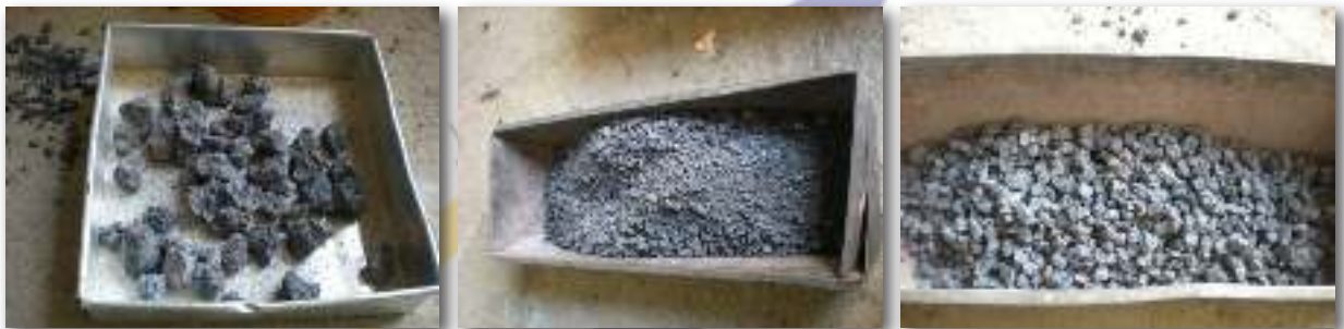
Gambar 6. Agregat Slag Baja Setelah melalui tahap penumbukan
