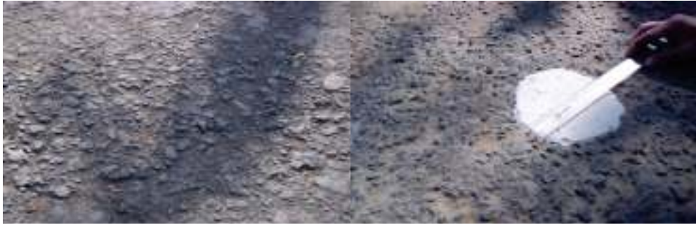
a. Kondisi eksisting mengalami penuaan dengan kedalaman tekstur = 0,31 cm
