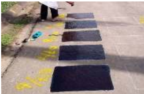
b. Pelaburan dengan aspal emulsi dengan variasi kadar residu 0,7; 0,8 dan 0,9 kg/m 2
