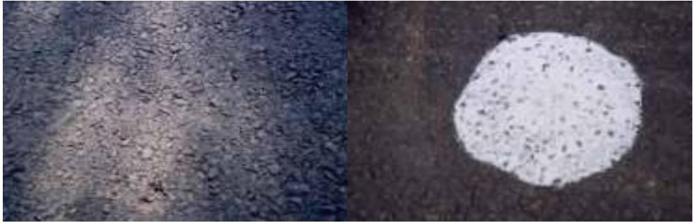
a. Kondisi eksisting mengalami penuaan dengan kedalaman tekstur = 0,084 cm
