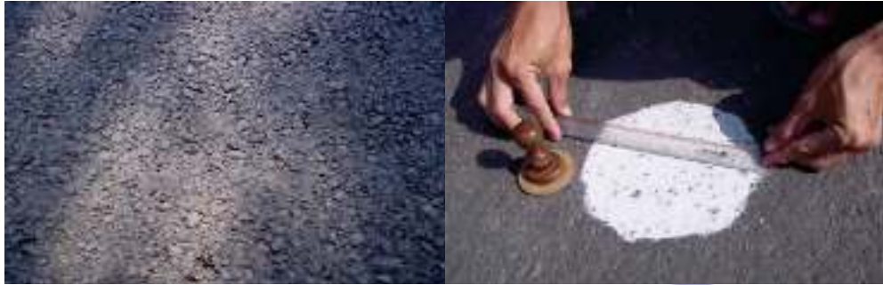
a. Kondisi eksisting retak halus dan penuaan dengan kedalaman tekstur = 0,076 cm
