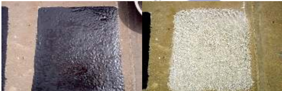
b. Pelaburan dengan aspal emulsi dengan variasi kadar residu 0,6; 0,7 dan 0,8 kg/m 2
