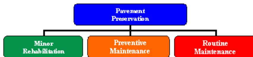
Gambar 2. Komponen-komponen Preservasi Perkerasan Jalan
