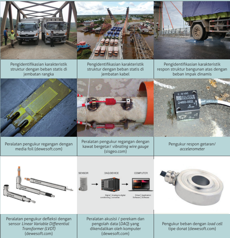
Gambar 19 Penjelasan Gambar Pengidentifikasi Karakteristik Struktur (Pelaksanaan Pengujian Pembebanan Jembatan)
