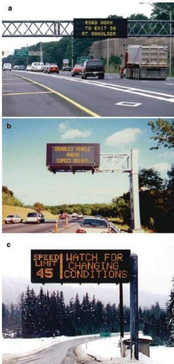
Gambar 414 (a) Changeable message sign yang menampilkan informasi konstruksi (Sumber:Parsons Brinckerhoff, Inc.), (b) Changeable message sign kecil yang menampilkan informasi insiden (Sumber:Daktronics, Inc.), (c) Changeable message sign yang menampilkan informasi cuaca dan pengendalian kecepatan (Sumber: Daktronics, Inc.)
