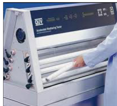
Gambar 17 Pengusangan FRP dengan sinar UV
