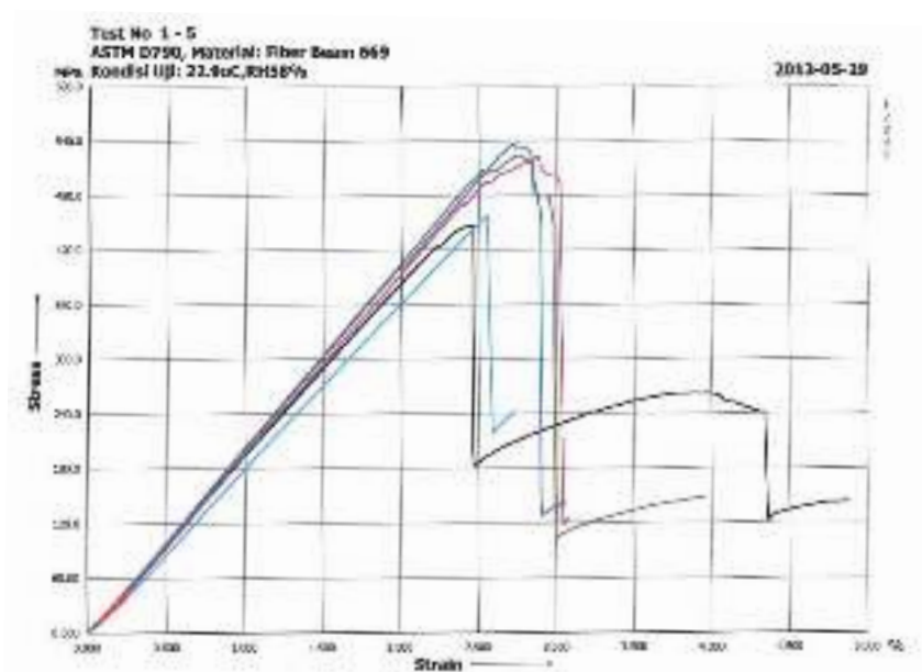
Gambar 5 Hasil uji lentur spesimen FRP ( t=7\text{mm} )
