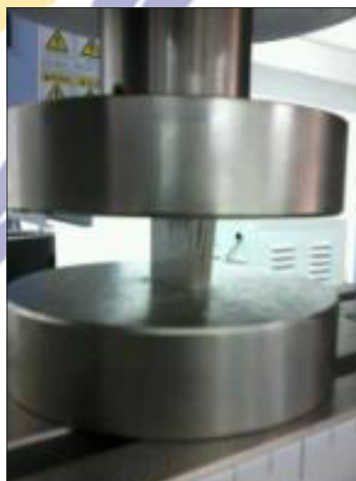
Gambar 6 Uji tekan FRP dengan UTM 50 kN
