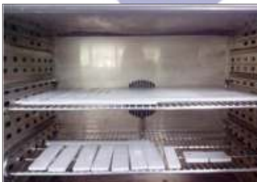
Gambar 16 Pengusangan FRP dengan oven
