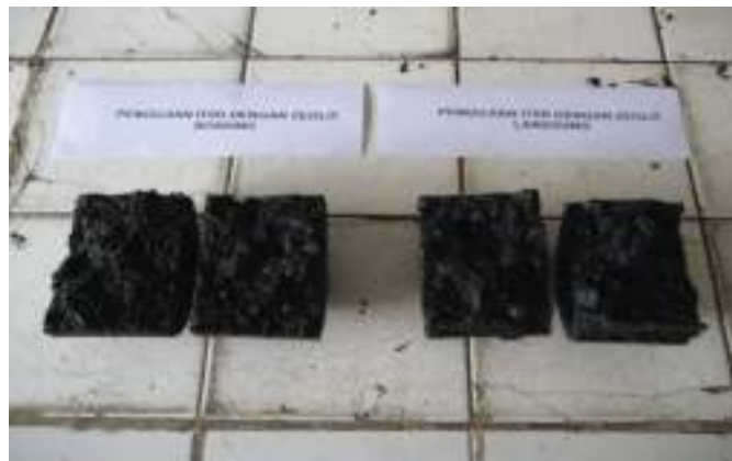
Gambar 4.31 Penampang belahan benda uji setelah pengujian ITS, campuran dengan zeolit
