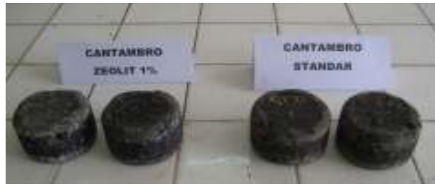
Gambar 4.24 Benda uji dengan dan tanpa zeolit yang telah diuji Cantabro
