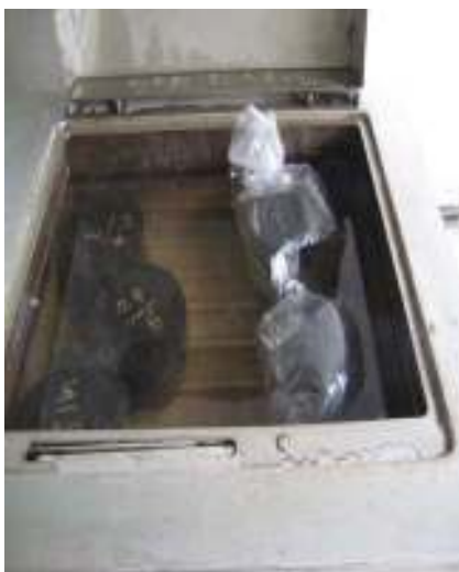
Gambar 4.28 Pengondisian contoh untuk uji Kuat Tarik Tidak Langsung (ITSR)
