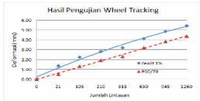
Gambar 4.21 Grafik ketahanan deformasi yang diuji dengan wheel tracking machine
