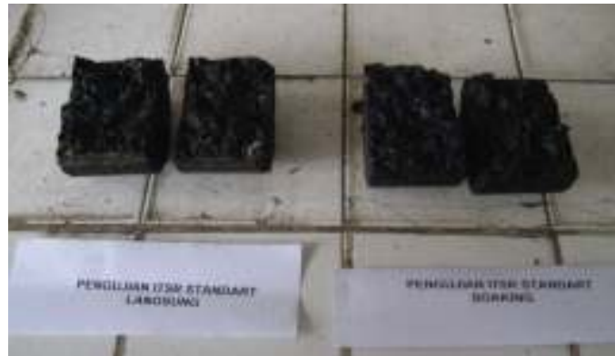
Gambar 4.30 Penampang belahan benda uji setelah pengujian ITS, campuran tanpa zeolit
