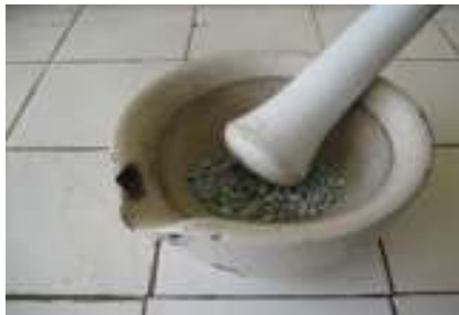
Gambar 4.15 Penghalusan butiran zeolit
