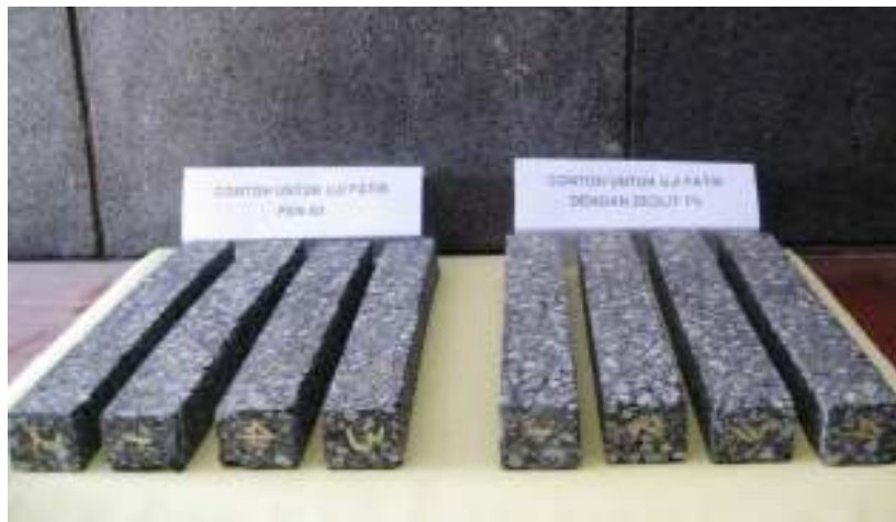
Gambar 4.33 Contoh benda uji untuk pengujian fatik
