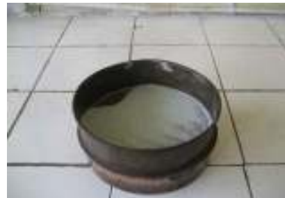
Gambar 4.16 Penyaringan zeolit hasil penghalusan dengan # 200
