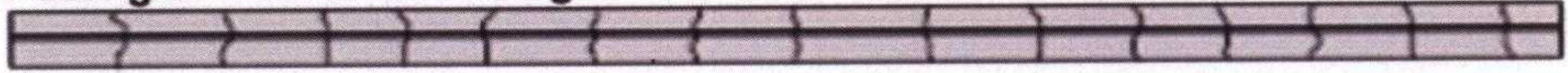
Gambar 1.4 Perkerasan beton menerus dengan tulangan (CRCP) (Sumber: FHWA, 2016)
