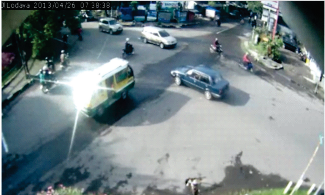
Gambar 5. Tipikal rekaman arus lalu lintas yang masuk simpang menggunakan kamera IP Fisheye
