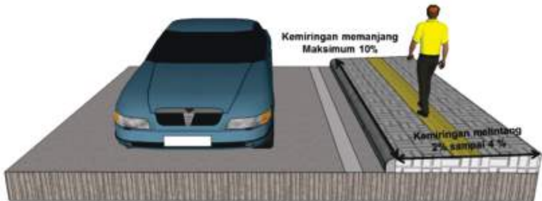
Gambar 1 - Kemiringan Melintang dan Memanjang Trotoar
