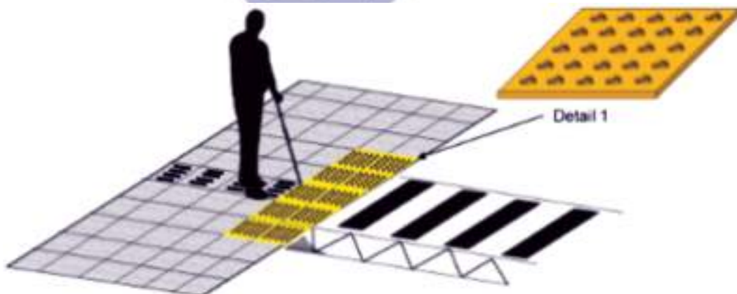
Gambar 2 - Penempatan ubin peringatan pada ujung lapak penyeberangan
