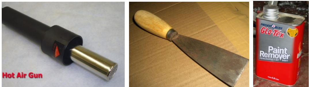
Gambar 71 Peralatan dan bahan untuk mengupas cat dari permukaan panel kusen pintu/jendela
