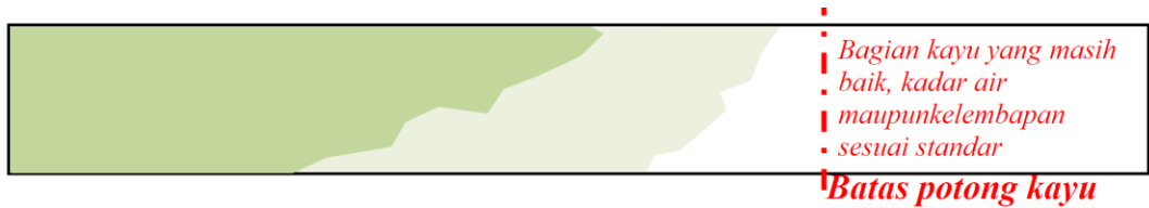
Gambar 81 Potong bagian yang mengalami pelapukan pada bagian kayu yang masih baik
