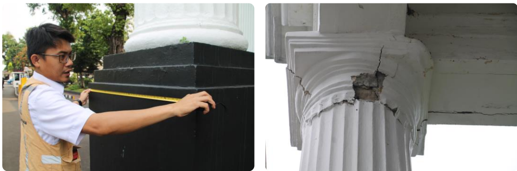
Gambar 100 Contoh pelaksanaan pemeriksaan visual pada bangunan cagar budaya Gedung Jusuf Anwar, Kementerian Keuangan
