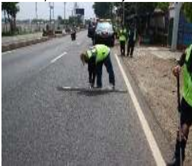
3) Pengukuran kedalaman alur
