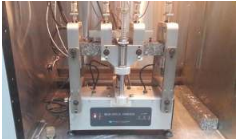
Gambar 3-4. Alat Beam Fatigue Apparatus (BFA) atau Four Point Bending Apparatus
