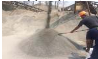
d. Agregat baru keluar dari mesin pemecah
