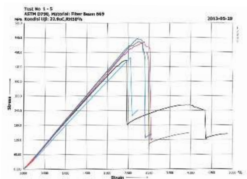
Gambar 5 Hasil uji lentur spesimen FRP ( t=7\text{mm} )
