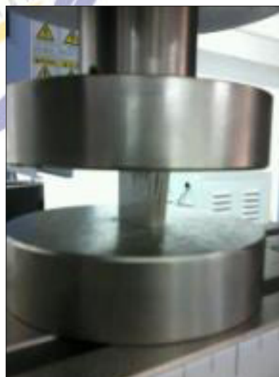
Gambar 6 Uji tekan FRP dengan UTM 50 kN
