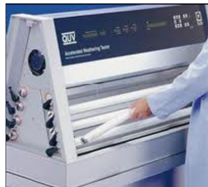
Gambar 17 Pengusangan FRP dengan sinar UV
