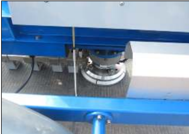
Gambar 6-2 Pengukuran lendutan pada sambungan melintang pelat beton
