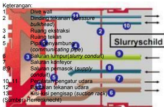
Gambar 4-23 Skema Mesin Lumpur ( Slurry Machine )
