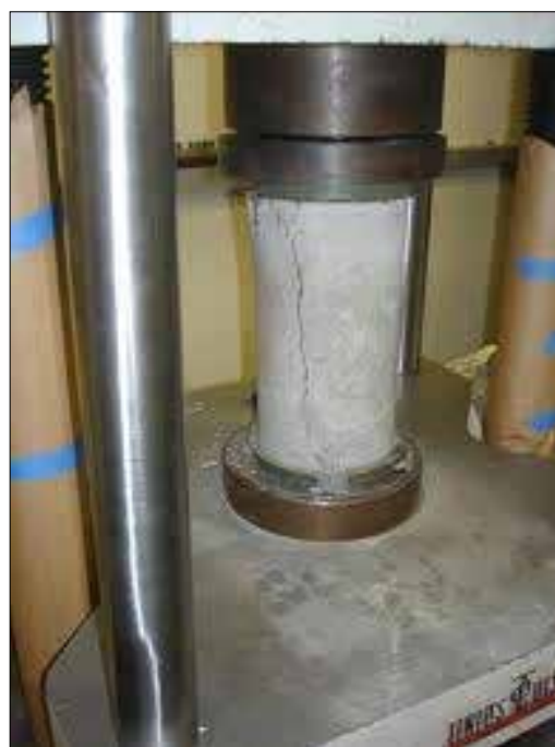
Gambar 8. Pengujian kuat tekan beton
