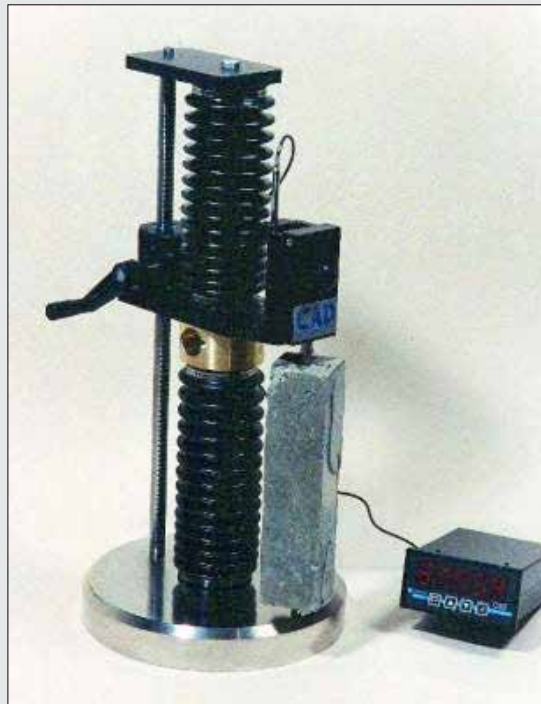
Gambar 15. Pengujian susut beton keras
