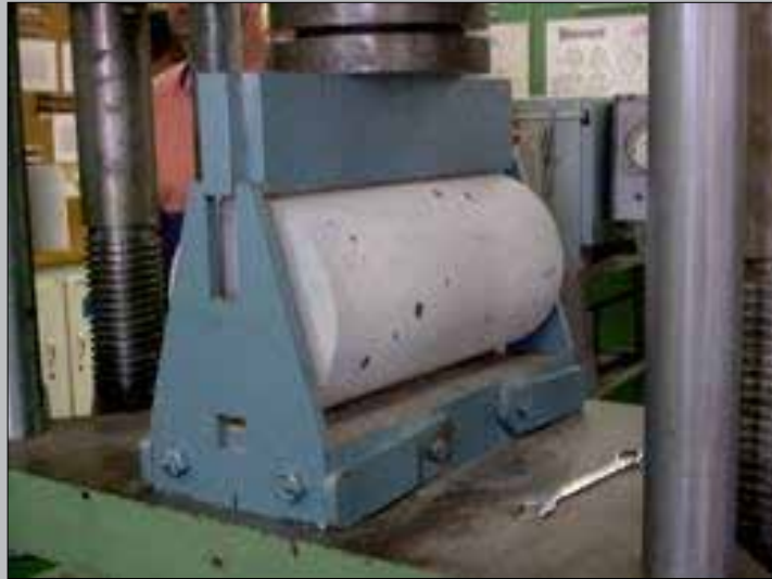
Gambar 7. Pengujian tarik belah beton
