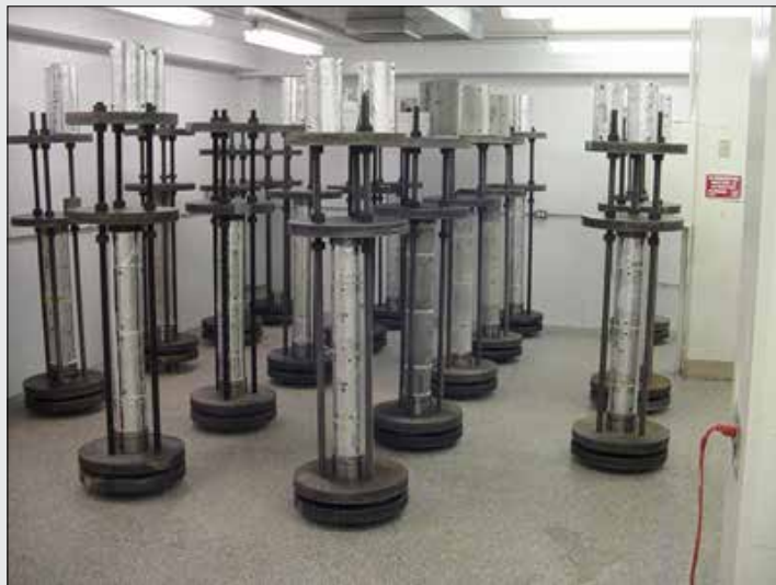
Gambar 16. Pengujian rangkai beton keras
