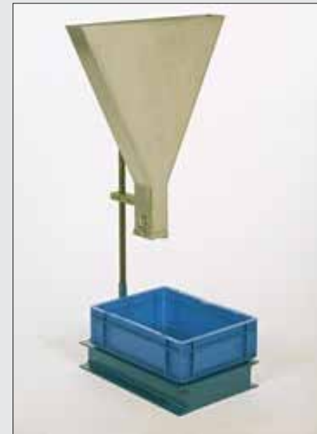
Gambar 12. Pengujian V Funnel
