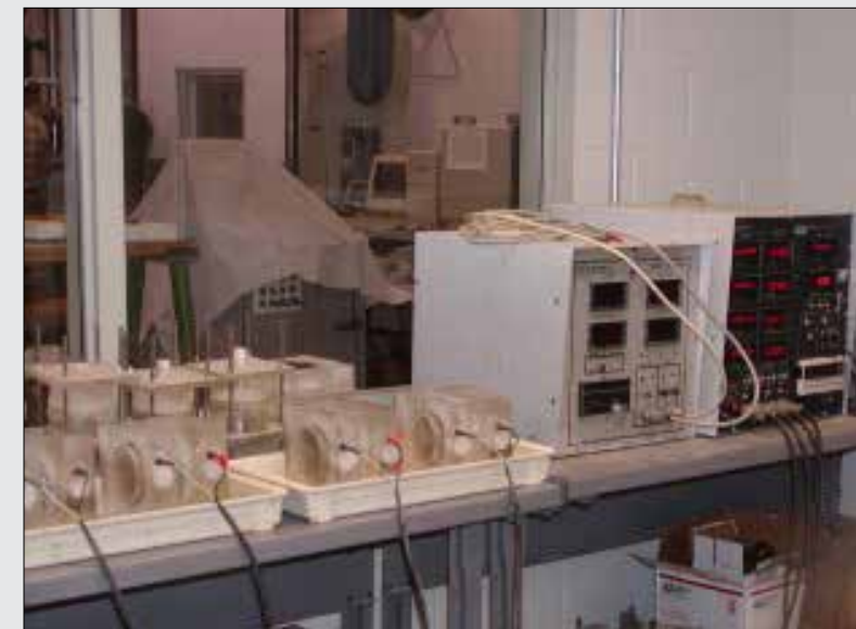
Gambar 14. Pengujian difusi klorida
