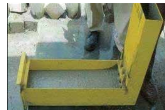
Gambar 11. Pengujian L Box
