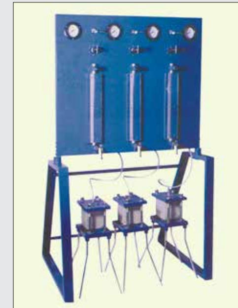
Gambar 13. Pengujian permeabilitas beton keras
