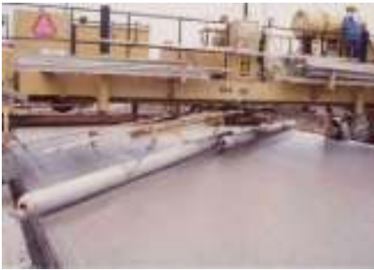
Gambar 58 Pelepa silinder ( Tube Floats ).
