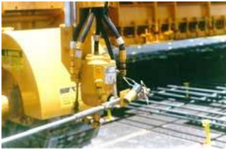
Gambar 45 Sensor elektronik pada acuan bergerak
