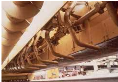
Gambar 28 Vibrator beton terletak di bawah mesin penghampar.
