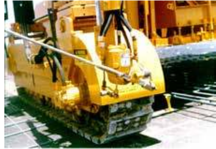
Gambar 45 Sensor elektronik pada acuan bergerak
