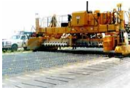
Gambar 42 Acuan bergerak dengan dua auger
