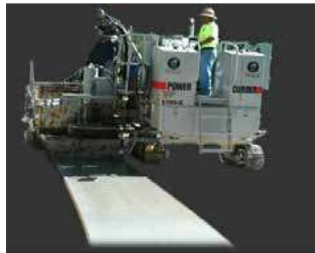
Gambar 37 Acuan bergerak untuk perkerasan jalan beton ukuran sedang
