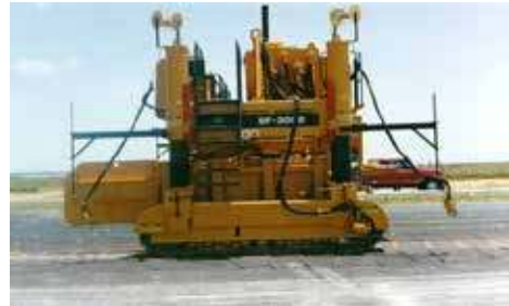
Gambar 47 Tampak samping mesin acuan bergerak
