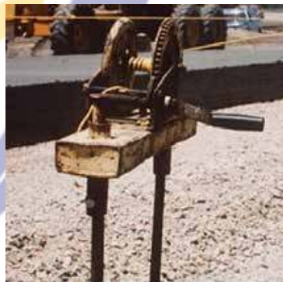
Gambar 49 Kawat pengendali tampak dari sisi lain
