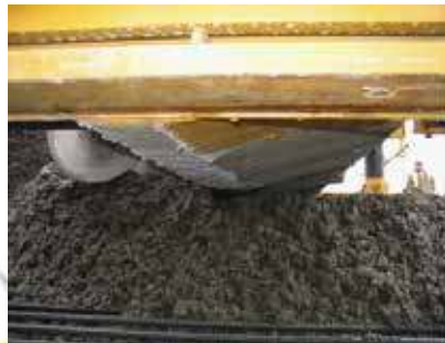
Gambar 51 Auger dan penyebaran beton
