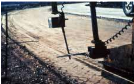
Gambar 46 Sensor horizontal dan vertikal
