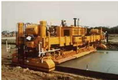
Gambar 41 Acuan bergerak dengan satu auger
