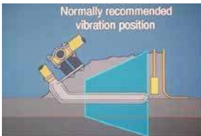
Gambar 54 Posisi Vibrator yang disarankan.
