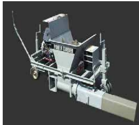
Gambar 39 Acuan bergerak untuk separator
