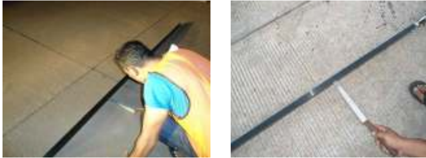
Gambar 102 Pengukuran kedalaman profil memanjang di bawah straight edge 3 m
