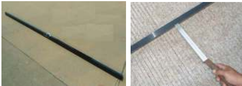
Gambar 100 Straight edge 3 m dan wedges
