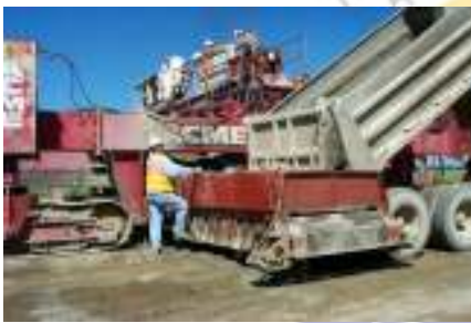
Gambar 24 Placer / spreader besar
