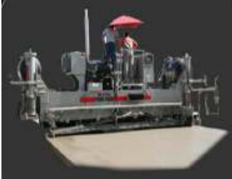
Gambar 36 Acuan bergerak untuk perkerasan jalan beton
