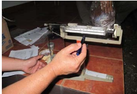
Gambar 4-10 Penimbangan Berat Contoh Tanah dalam Krus (Dok. Pusjatan, 2012)
