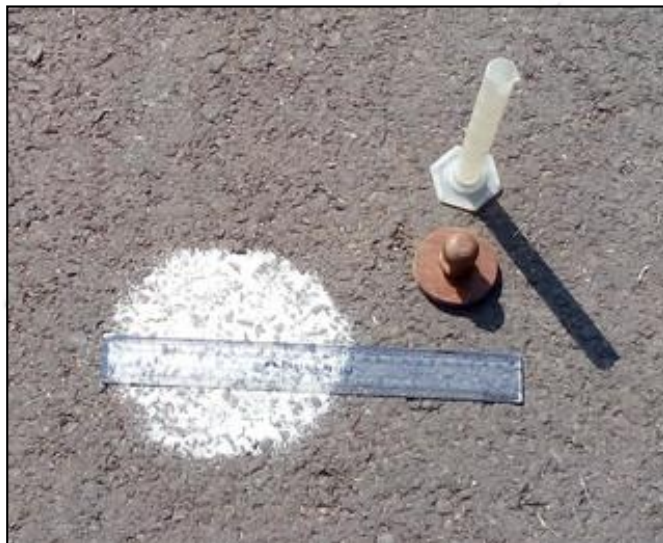
Gambar 6. Peralatan pengujian kedalaman tekstur dengan metoda Sand Patch
