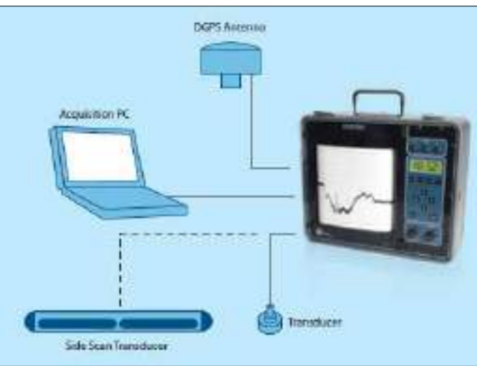
Gambar 6 Konsep survei Batimetri dengan menggunakan Echosounder ( http://dennipasca.blogspot.com/2010/09/konsep-dasar-survei-batimetri.html )
