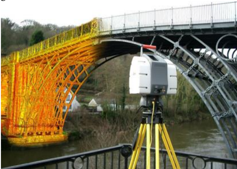
Gambar 76 Akuisisi Data dengan TLS
