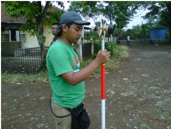
Pengukuran KDH menggunakan ETS (2)
