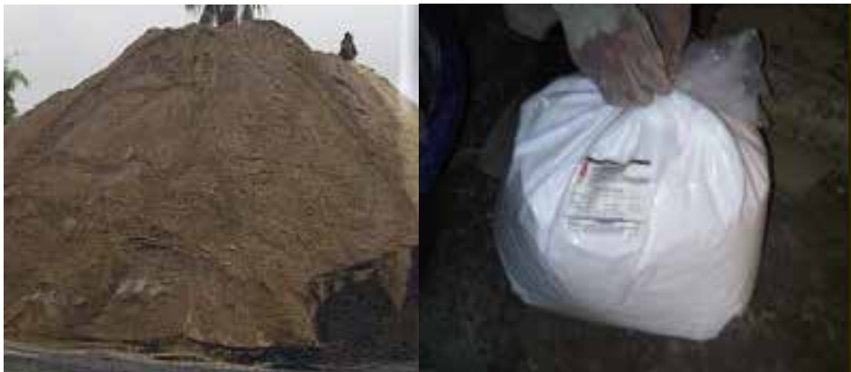
Gambar 2.3. Pasir silika bangka yang diproses menjadi nanosilika dan nanosilika komersil
