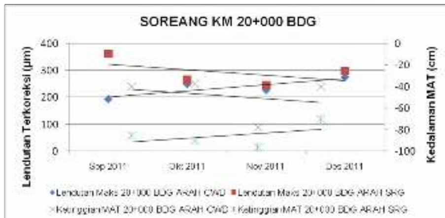
Gambar 7-5 Nilai lendutan maksimum terkoreksi vs ketinggian MAT lokasi Soreang KM 20+000 BDG
