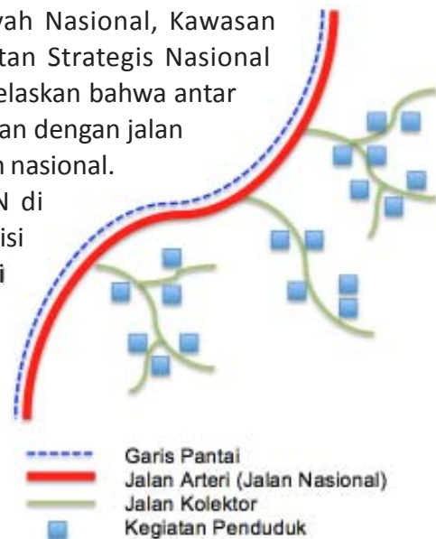
Pola Jaringan Jalan Linier Tepi Pantai
