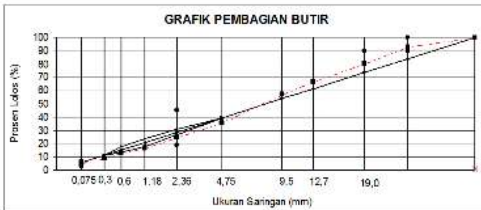
Gambar 5. Gradasi AC-Base dengan RAP 14,2 %
