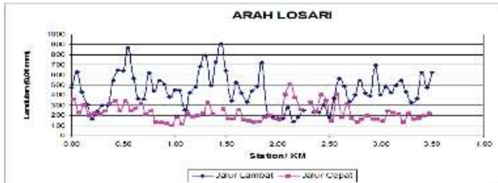
Gambar 3. Nilai Lendutan Perkerasan Arah Losari
