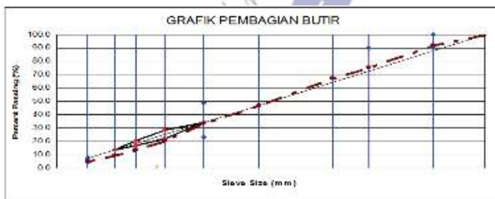
Gambar 6. Gradasi AC-Binder dengan RAP 9,5 %
