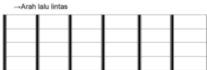
Gambar 54a - Pemasangan panel beton secara memanjang
