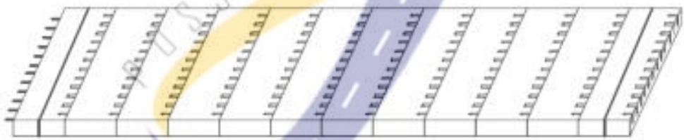
Gambar 1 - Perkerasan beton pracetak (tanpa prategang)
