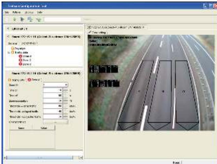
Gambar 4 - Proses Membuat Virtual Loops Menggunakan Perangkat lunak Melalui Layar Monitor
