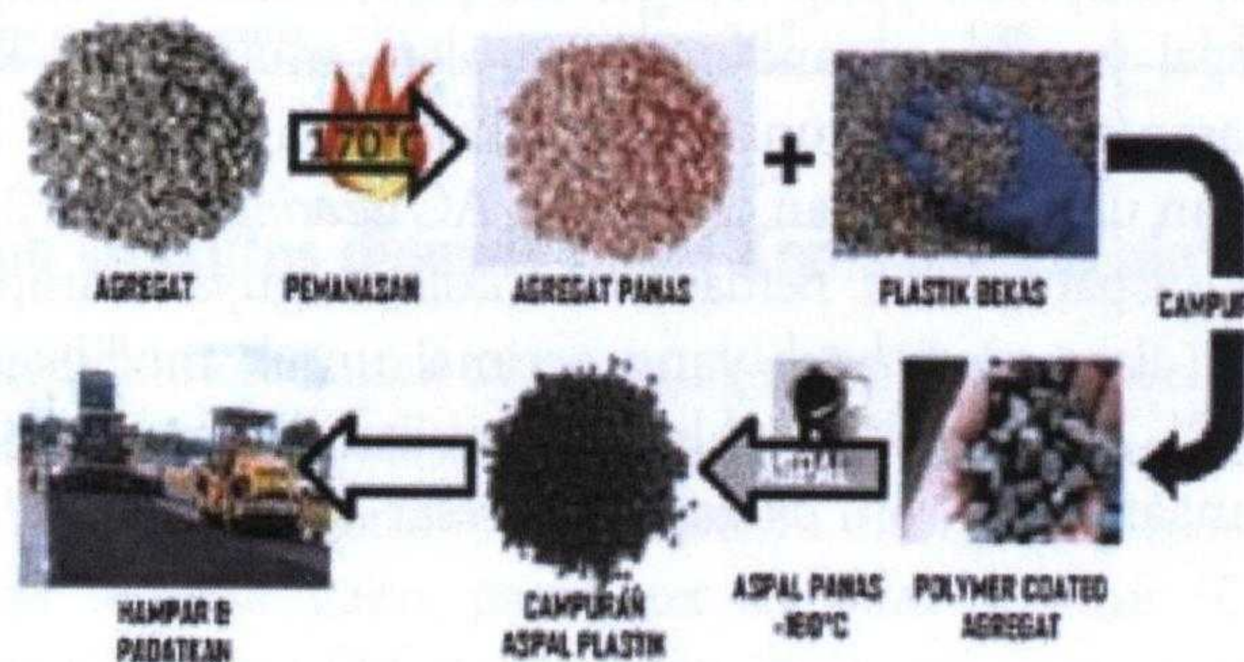
Gambar 2.4. Ilustrasi Metode Pencampuran Dry Process
