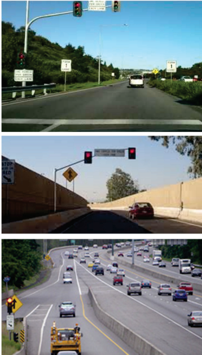
Gambar 3.12 Contoh pemasangan ramp metering
