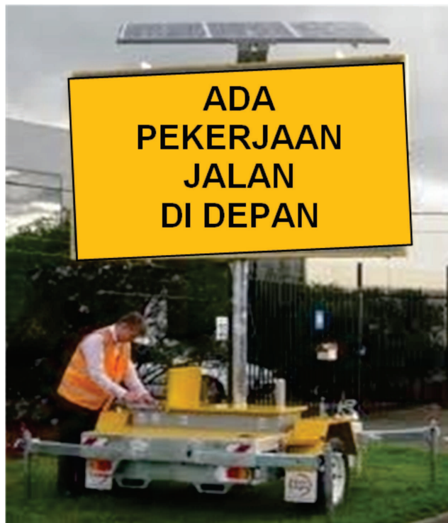
Gambar 3.11 Portabel DMS dan VMS yang bisa dipindah-pindah
