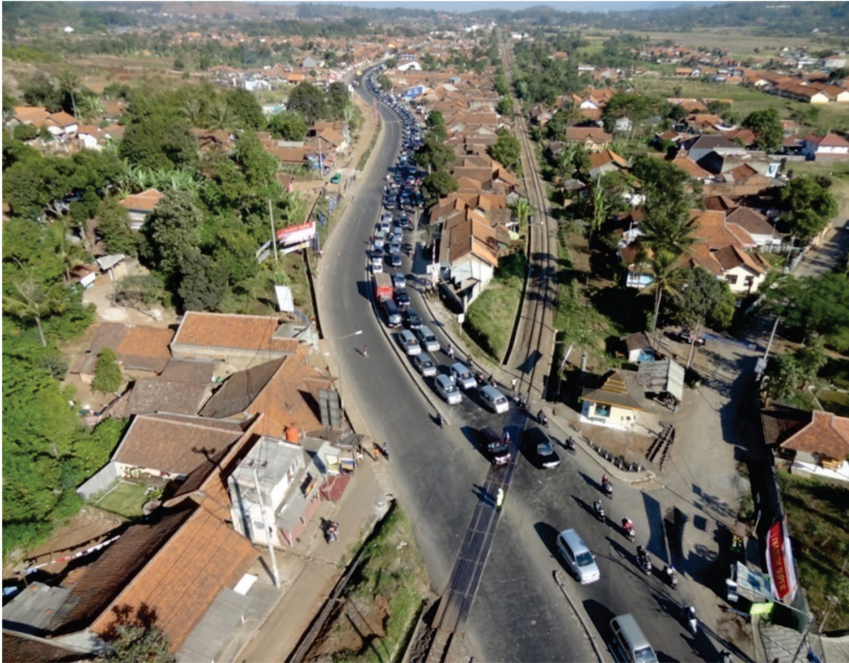
Gambar 2.13 Hambatan karena adanya fasilitas perlintasan kereta api sebidang
