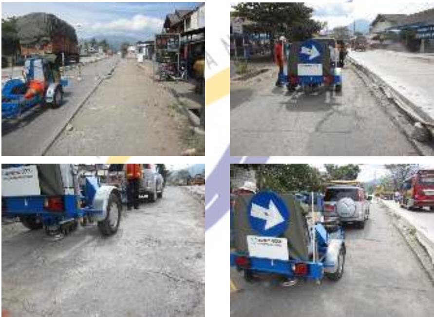
Gambar 4. 19 Pengujian lendutan dengan alat FWD di Sumedang 1
