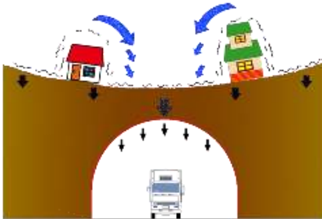
Gambar 2.14. Penurunan permukaan akibat tidak bekerjanya ground arch (Awaji, 2012)
