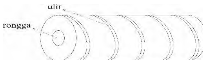
Gambar 16 Lilitan fiber sensor pada silinder
