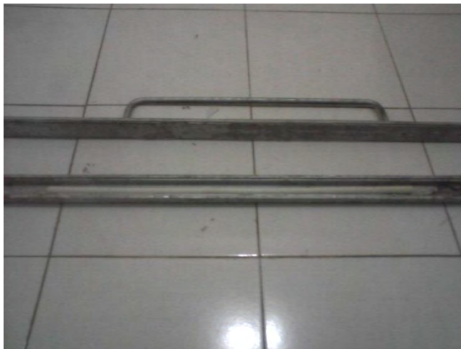
Gambar 20 Cetakan untuk menanam silinder berulir dengan rubber silicone
