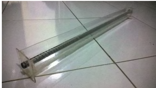
Gambar 23 Cetakan resin dan besi berulir
