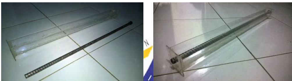
Gambar 17 Contoh cetakan resin dengan besi berulir yang telah dibuat
