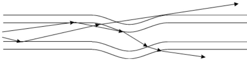
Gambar 8 Proses terjadinya mikrobending (Bailey, 2003)
