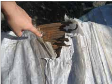
Gambar 4.39 Kabel Prestress yang digunakan pada jembatan
