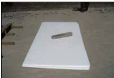
Gambar 4.21 Polystyrene Foam yang digunakan pada jembatan
