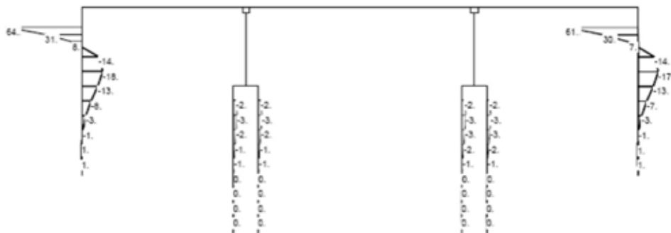
Gambar 6.8 Pile Bending Moments dalam pembebanan Gempa
