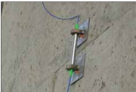
Gambar 11 Sensor fiber optic di Jembatan Suramadu
