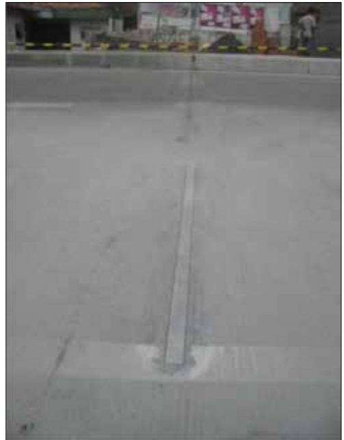
Gambar 12 Sensor WIM di jalan akses masuk Jembatan Suramadu
