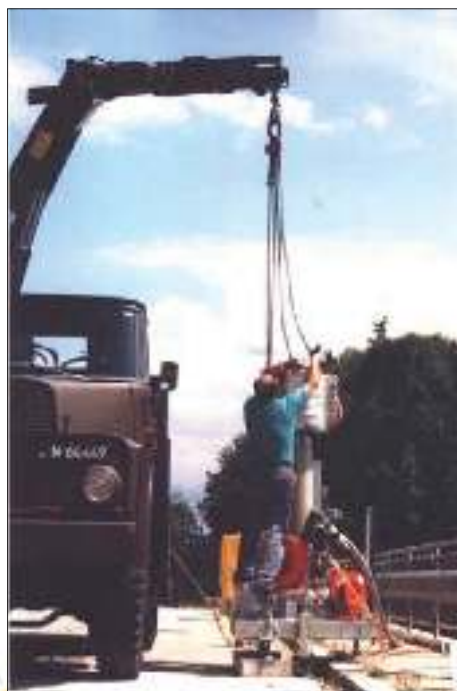
Gambar 10 Pemasangan reaksi penggoyang masa (mass shaker) (EMPA)
