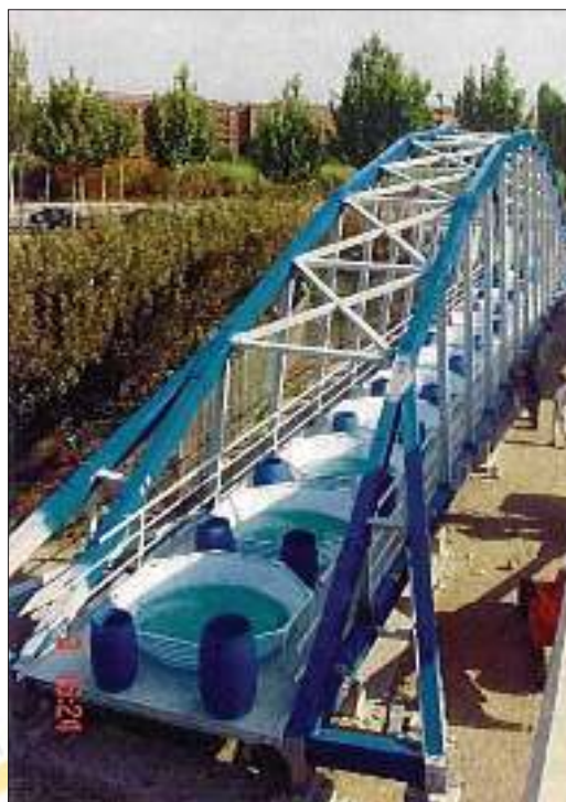
Gambar 2 Pengujian beban statik menggunakan tangki air
